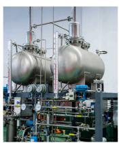
(2) 纯化装置:净化氢气的设备,能将 氢气中的氧气和水分去掉。以水电解氢气 为原料气,经过催化除氧、冷却冷凝、吸 附二级干燥和高效过滤后获得高纯氢气。 采用三塔流程,三台干燥器交替工作、再 生、吸附,以实现整套装置工作的连续性。 并使用产品氢气为再生气,再生效果好, 产品的氢气的露点可达到-70°C以下。
